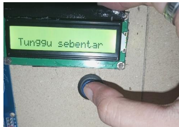
Gambar 10. Pengujian Bel Tamu Saat Terbuka
