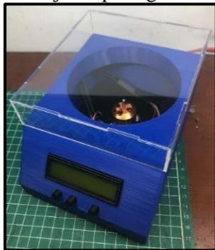
Gambar 5. Hasil Chamber *Spin Coater*
