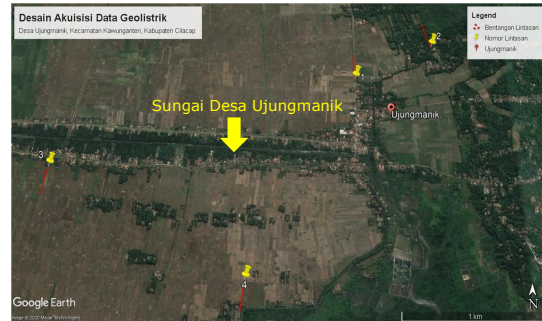
Gambar 4. Desain akuisisi data geolistrik konfigurasi Wenner di Desa Ujungmanik Kecamatan Kawunganten Kabupaten Cilacap
