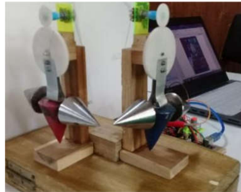
Gambar 12. Susunan sensor kemiringan arah X dan Y
