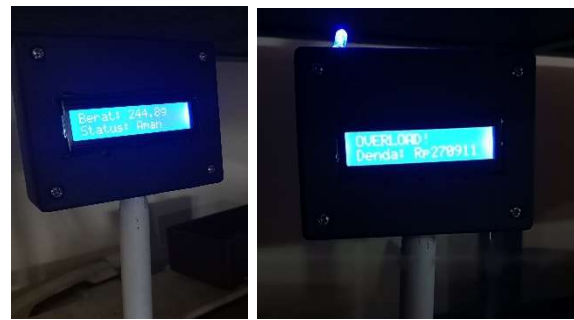
Gambar 11. Tampilan antarmuka lokal (a) Ketika kondisi normal, (b) Ketika terjadi kelebihan muatan
