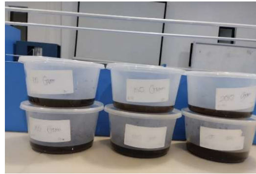
Gambar 3. Sampel direndam pada larutan ekstrak ampas kopi
