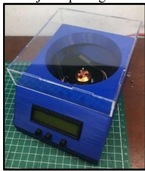
Gambar 5. Hasil Chamber *Spin Coater*
