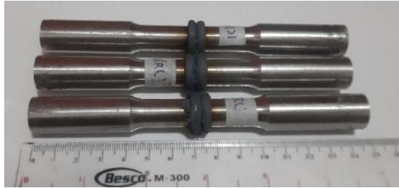
Gambar 2. Hasil sambungan las rotary friction welding
