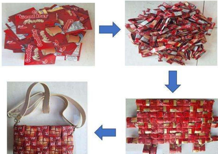
Gambar 5. Langkah-langkah pembuatan produk kerajinan tas
