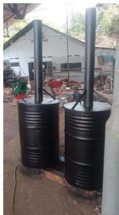
Gambar 6. Alat pembuat biochar
