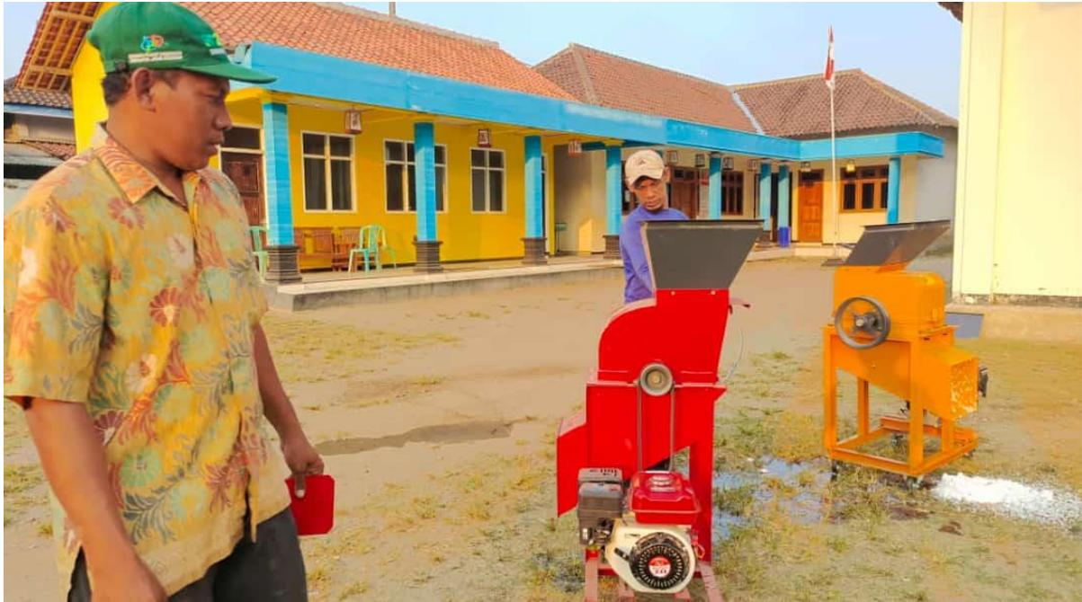
**Gambar 8.** Mesin pencacah sampah yang dioperasikan di Pantai Suwuk, mesin berwarna merah adalah mesin pencacah sampah organik sedangkan mesin berwarna kuning adalah mesin pencacah sampah anorganik
