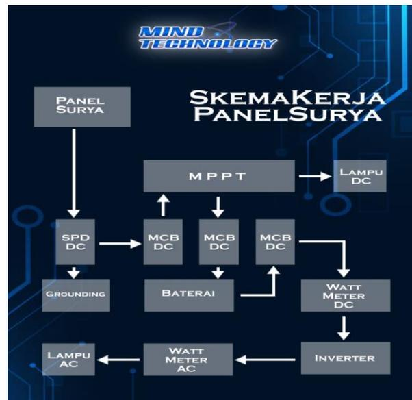
**Gambar 1. Skema Kerja Modul PLTS Atap**
