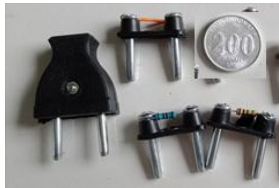
Gambar 3. Steker stop kontak yang dimodifikasi menjadi resistor.
