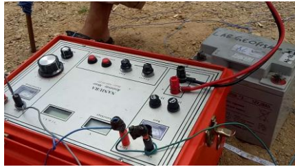
Gambar 4. Peralatan Resistivitymeter tipe NANIURA model NRD300 yang digunakan dalam akuisisi data.
