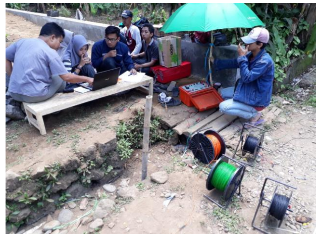
Gambar 6. Kegiatan akuisisi data resistivitas pada survei geolistrik di sekitar Masjid Al-Jihad, Desa Metenggeng, Kecamatan Bojongsari, Kabupaten Purbalingga.
