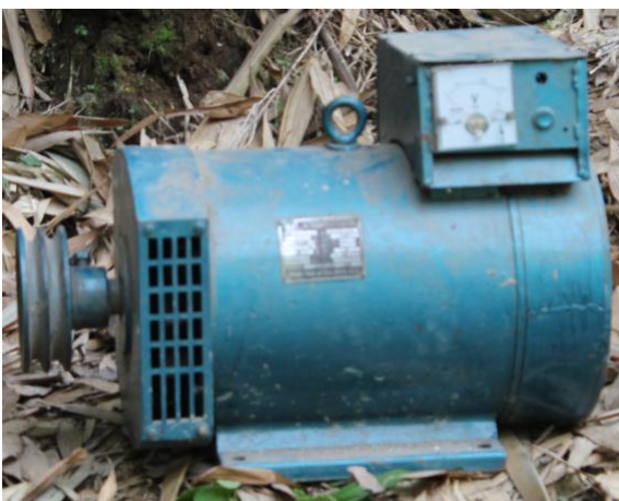
Gambar 7. Generator listrik PLTA pikohidro
