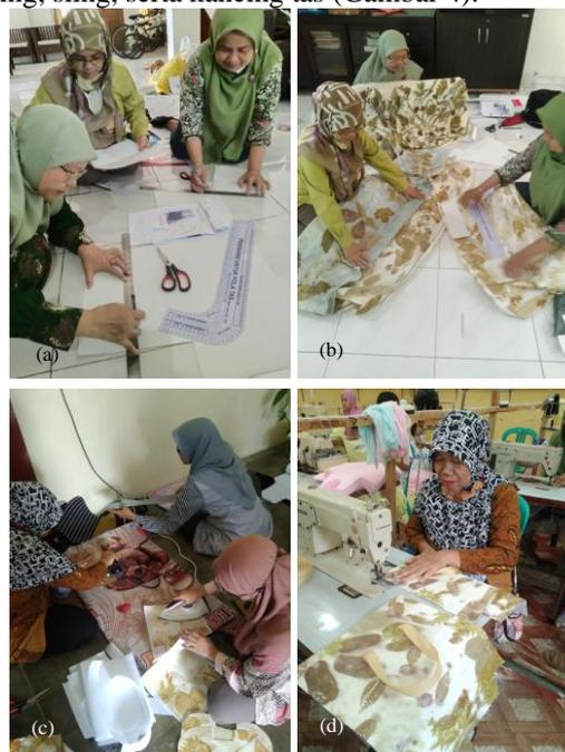
**Gambar 3.** Pembuatan tas meliputi (a) pembuatan pola tas, (b) pengguntingan kain sesuai pola tas, (c) perekatan busa perekat pada kain, dan (d) penjahitan tas menggunakan mesin jahit industri.
