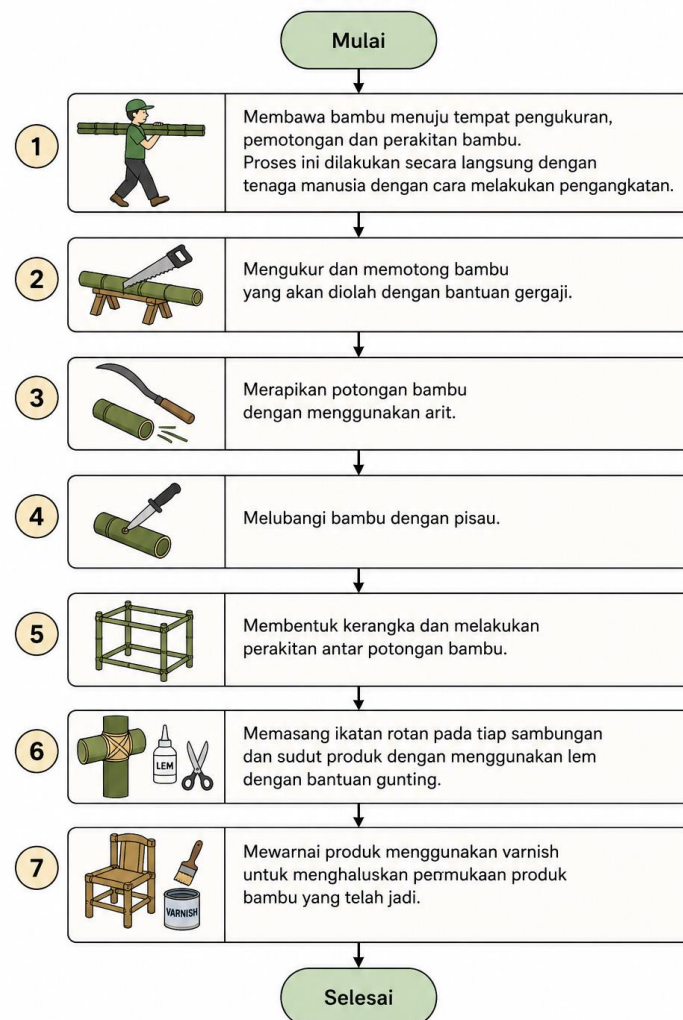
Gambar 1. Diagram Alir Proses Produksi Kerajinan Bambu
