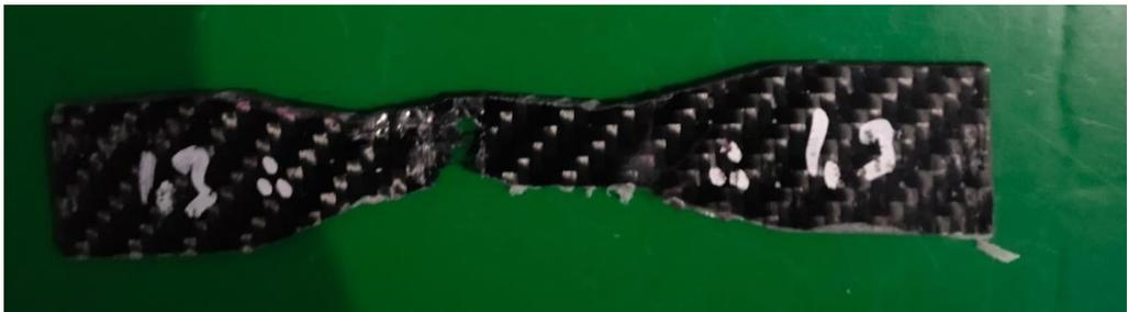
**Gambar 6.** Pengujian tarik variasi lapisan 9 dengan tekanan vakum 1,3 bar
