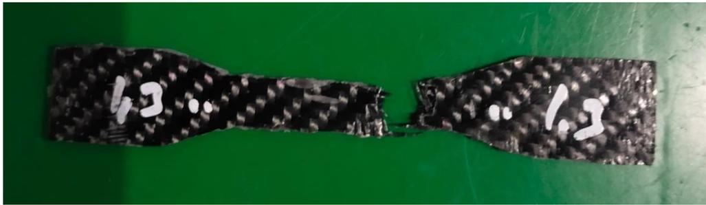
**Gambar 5.** Pengujian tarik variasi lapisan 7 dengan tekanan vakum 1,3 bar
