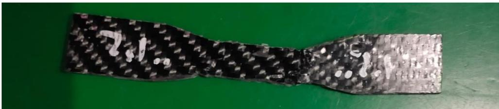
**Gambar 7.** Pengujian tarik variasi lapisan 7 dengan tekanan vakum 1,5 bar
