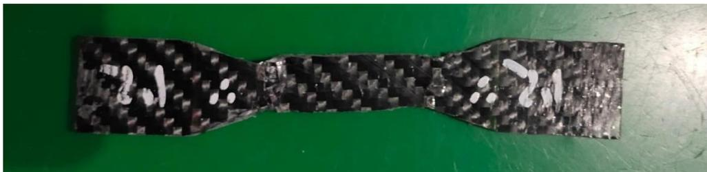
**Gambar 8.** Pengujian tarik variasi lapisan 9 dengan tekanan vakum 1,5 bar
