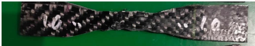
**Gambar 3.** Pengujian tarik variasi lapisan 7 dengan tekanan vakum 1,0 bar
