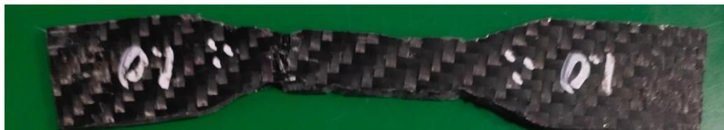
**Gambar 4.** Pengujian tarik variasi lapisan 9 dengan tekanan vakum 1,0 bar
