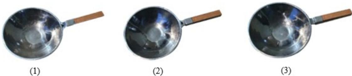
**Gambar 5.** Hasil pengecoran Aluminium A356 tahap 2 pada desain *wok pan* 1, 2 dan 3
