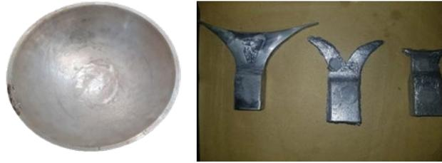
**Gambar 3.** Hasil pengecoran aluminium A356 tahap 1
