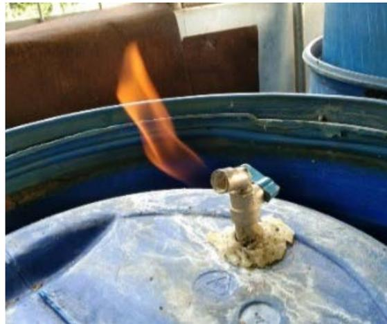
**Gambar 6.** Warna api biogas tanpa pemurnian (kontrol)
