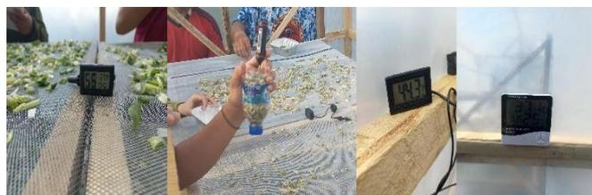
Gambar 1. Pengukuran suhu secara berurut dari kiri kekanan, yaitu: suhu tiap tingkatan, suhu bahan, suhu didalam ruang pengering, dan suhu lingkungan
