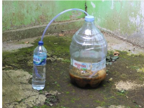
Gambar 2. Pemasangan Selang Saluran Udara
