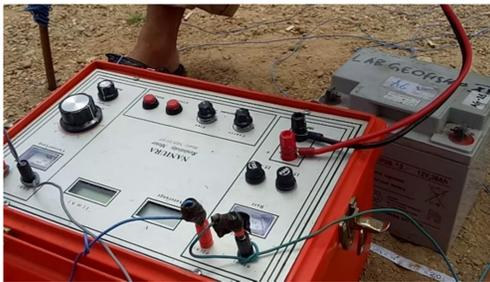
**Gambar 3.** Peralatan Naniura Resistivity meter yang digunakan dalam akuisisi data resistivitas.
