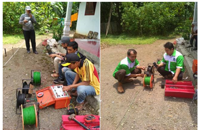
Gambar 6. Kegiatan akuisisi data resistivitas pada survei geolistrik di sekitar Masjid Sabilul Huda, Desa Kemranjen, Kecamatan Jatilawang [11].
