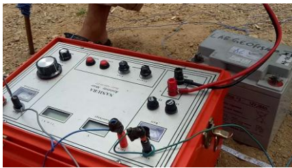
Gambar 3. Peralatan Resistivimeter tipe NANIURA model NRD300 yang digunakan dalam akuisisi data.
