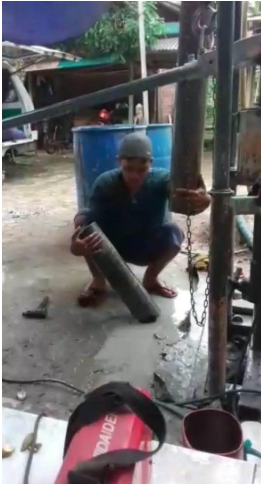
Gambar 9. Pengangkatan batuan beku basalt berbentuk silinder dari peralatan bor (dokumentasi pribadi)
