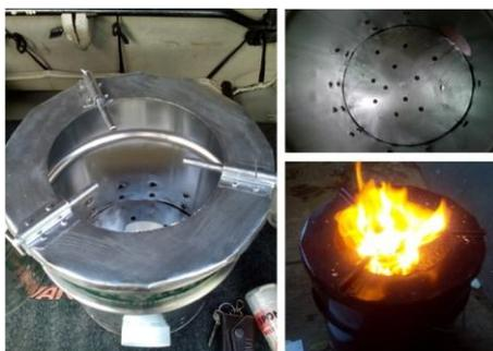
**Gambar 3.** Realisasi tungku hemat energi berbahan dasar kaleng bekas dengan bahan bakar sekam padi untuk skala rumah tangga.
