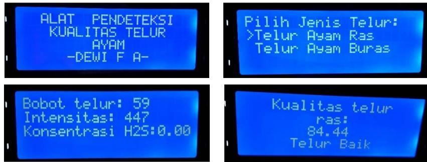
Gambar 3. Tampilan pengujian alat
